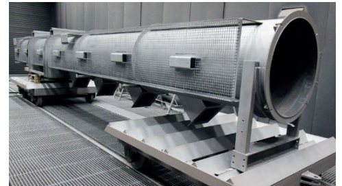
Die zu bearbeitenden Bauteile haben eine Länge bis 18 m und ein Gewicht bis 20 t.
